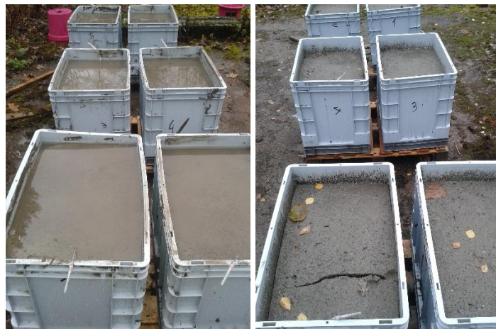
Figure 2-8 : Dispositif expérimental en mésocosme avant et après séchage des sédiments
