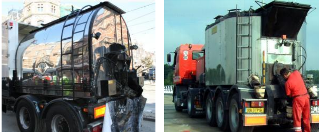
Figure I.54 (à droite) malaxeurs à axe vertical (à gauche) Malaxeurs à axe horizontal
