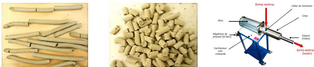
Figure I.31. Présentation du produit confectionné à l'extrudeuse [7]
