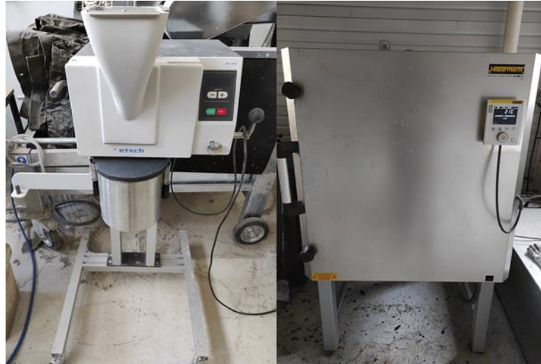
Figure III.4 A droite : Four Nabertherm, A gauche Broyeur à fléaux Sk300 Retsch
