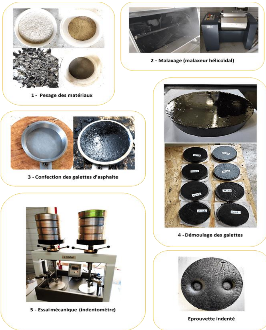
Figure III.20 Formulation des éprouvettes de l'asphalte coulé d'étanchéité pour essai d'indentation
