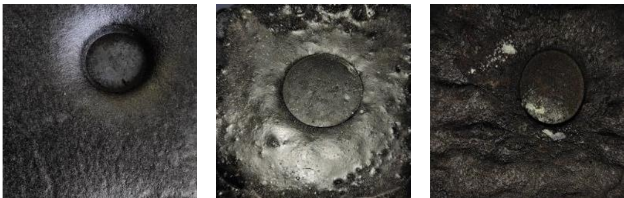
Figure IV.24 Morphologie des asphaltes immergés dans différentes solutions
