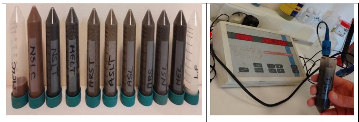
Figure III.9 (à gauche) Solution eau déminéralisé et fillers (à droite) Essai de PH
