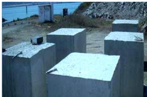
Figure I.30. Blocs de béton à base de sédiment ([56])
