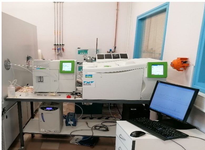
Figure 6 : Exemple de chaîne d'analyse de COV on-line Perkin-Elmer (IMT Lille Douai, CERI EE) incluant un module de préconcentration par effet Peltier sur adsorbant solide (à gauche), une ligne de transfert chauffée et un chromatographe en phase gazeuse (à droite)
