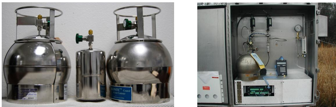
Figure 5 : (à gauche) : Canisters de différents volumes – (à droite) : système de prélèvement automatique (Bunch, 2012)
