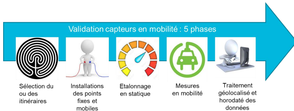
Figure 1 : synoptique du protocole de qualification en mobilité
