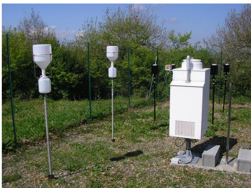
**Figure 2 : Exemple de collecteurs (à Peyrusse-Vieille, France – Photo Atmo Occitanie) de dépôt humide - Eigenbrodt et de dépôt total – jauge Nilu avec entonnoirs ou jauge Bergerhoff.**
