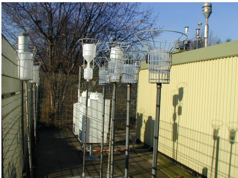
**Figure 1 : Exemple de collecteurs (à Duisburg, Allemagne – photo D. Gladtkke) de dépôt humide - Eigenbrodt et de dépôt total – jauge Nilu avec entonnoirs ou jauge Bergerhoff.**
