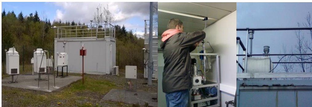
Figure 5 : La campagne EMEP/ACTRIS/COLOSSAL en hiver 2018, avec à gauche, une vue générale de la station Revin, au centre, l'installation de l'ACSM et à droite, une vue des têtes de prélèvement sur le toit de la cabine (photos IMT Lille Douai – V. Riffault, S. Sauvage)
