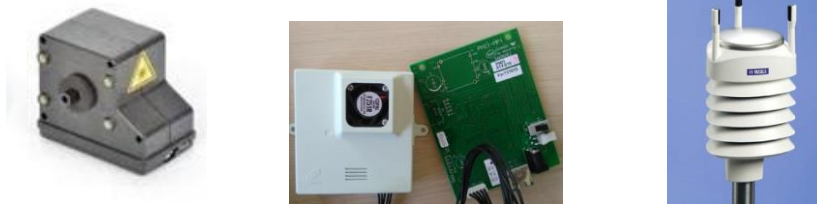
Figure 17 – Micro-capteurs ou mini-station testés par le protocole, de gauche à droite : Alphasense OPC N2, Shinyei PPD60PV, Vaisala AQT420
