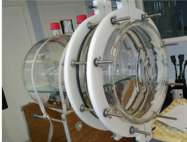
Figure 5 - Typologie de la chambre d'exposition de 36L en Pyrex
