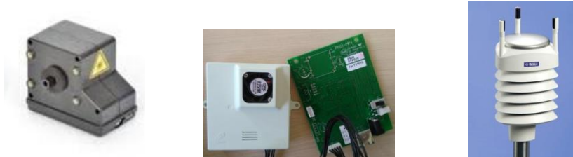
Figure 17 – Micro-capteurs ou mini-station testés par le protocole, de gauche à droite : Alphasense OPC N2, Shinyei PPD60PV, Vaisala AQT420
