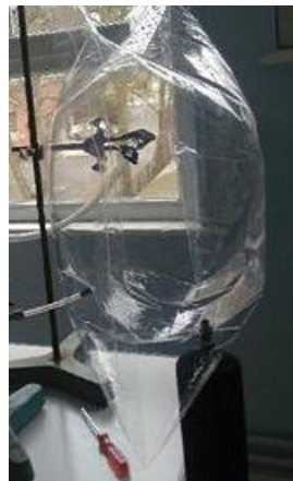
Figure 4 – Le sac Téflon : un bon compromis pour une chambre d'exposition à bas coût
